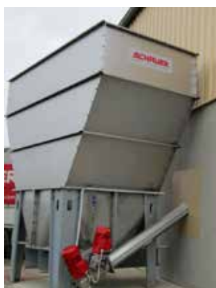
Tender-CCM prednádrž z nerezovej ocele s objemom do 8 m 3
