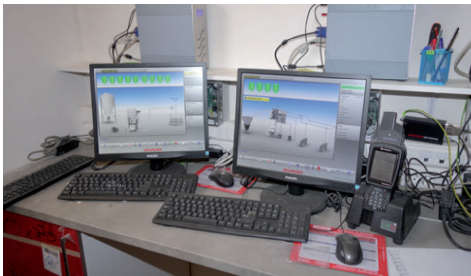
Počítače Topo riadia systém kŕmenia a pomocou internetového pripojenia je možný servis z ktorejkoľvek časti zeme
