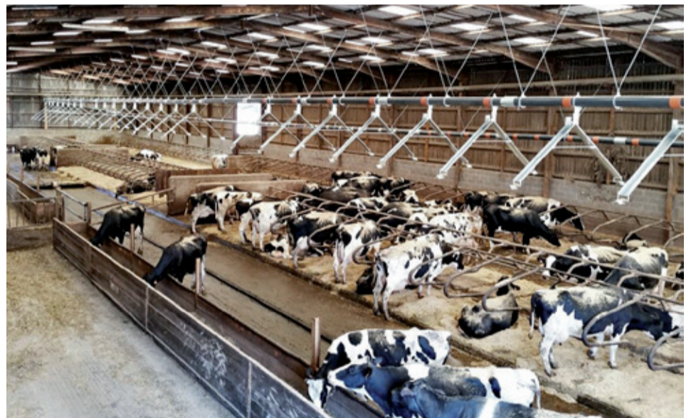
Slama sa rozdeľuje v maštali cez zavesenú dopravnú líniu. Primontovaním rozdeľovačov sa slama rozdelí do boxov.
